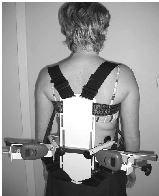
Obr. 1 - Znázornění fixace svalového dynamometru SD01 na subjektu.
