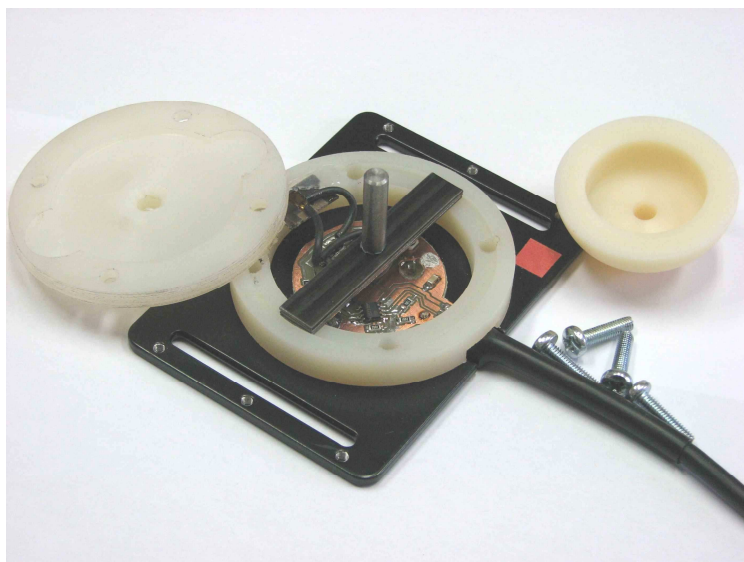
Obr. 2. Silový senzor Fig. 2. Sensor pad (internal view)
